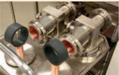
ABSORBERY MODÓW PASYWNYCH W PROJEKcie XFEL
