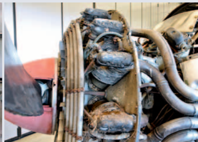
SILNIK PRZED REMONTEM, ZE ŚLADAMI PO DAWNYCH LOKATORACH. FOT. J. ZAGOŹDZON
