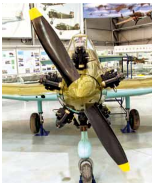
■ ŚMIGŁO SAMOLOTU TS-9 JUNAK 3 PRODUKOWANE W JEDNEJ Z WYTWÓRNI SPRZĘTU KOMUNIKACYJNEGO
